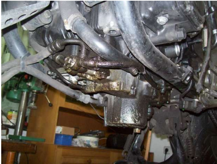
Motorunterseite nach Abnahme der Schalldämpferanlage: Die vordere Ölleitung ist undicht.
