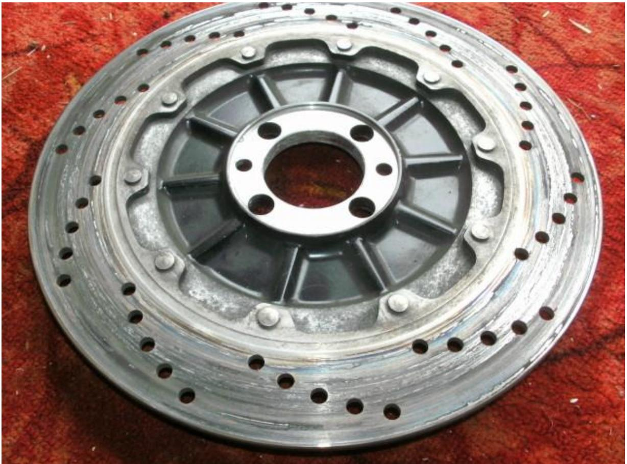
Dazu muss man die drei Innensechskantschrauben ausdrehen. Die sitzen so fest, dass der kleine Innensechskant sofort rund ist, man kann also gleich den Torx 20 reinhämmern, damit lassen sich die Schrauben gut lösen.
