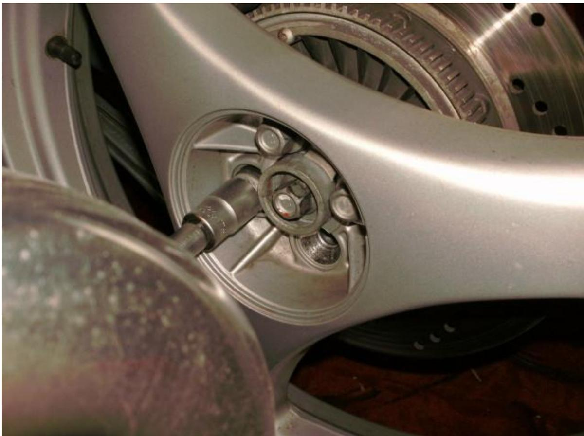
Um die Scheibe bzw. den Bremsring zu tauschen, muss erst einmal die Bremsscheibe nebst Scheibenträger und Impulsring ausgebaut werden. Dies ist schnell geschehen, das Hinterrad ausbauen, die beiden 5er Innensechskantschrauben der Trägerplatte lockern, (Einbaulage markieren) den Bremssattel abschrauben und abnehmen, Bremsscheibe herausnehmen.
