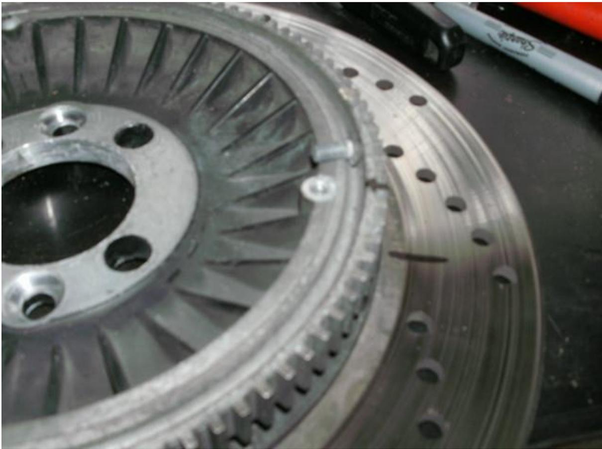
Der ABS-Impulsring ist dünn und aus Aluminium, dazu sitzt er recht fest auf dem Scheibenträger. Vorsichtiges Erwärmen mit der Heißluftpistole und ebenso vorsichtiges Abhebeln mit einem breiten Schraubendreher macht ihn gefügig.
