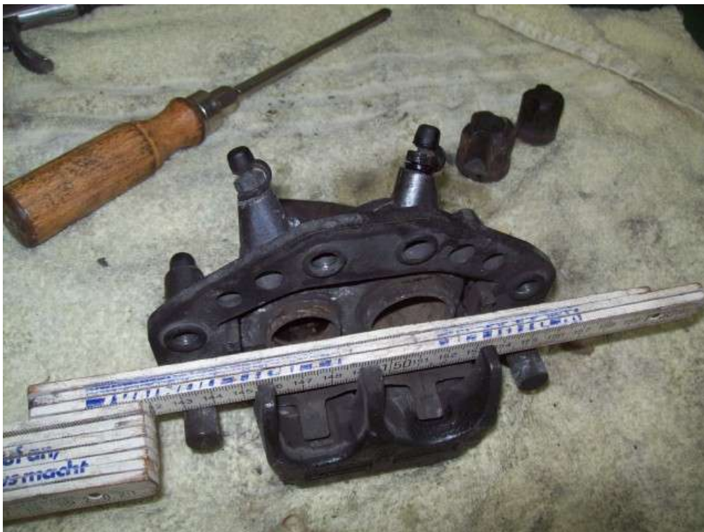
Schwimmsattel mit abgebauten Belägen, die Inlays der Kolben sind herausgenommen.
