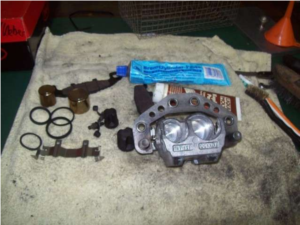
Geschrubbt, getrocknet, ausgeblasen, mit Bremszylinder- und Kupferpaste versehen...
