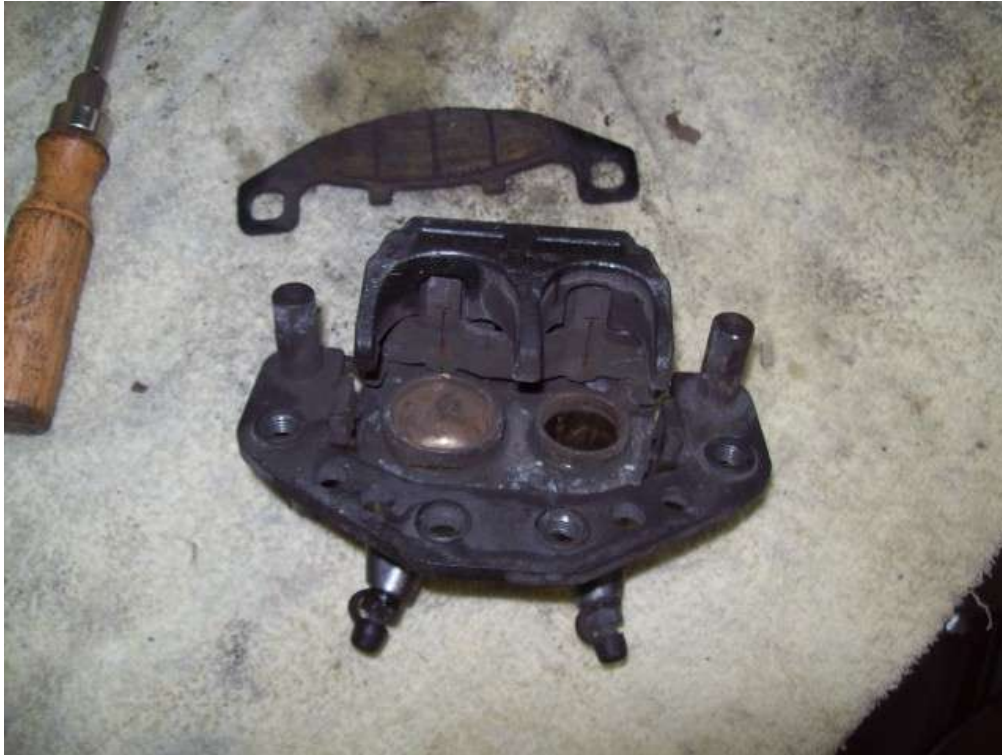
Schwimmsattel mit abgebauten Belägen, die Inlays der Kolben sind herausgenommen.
