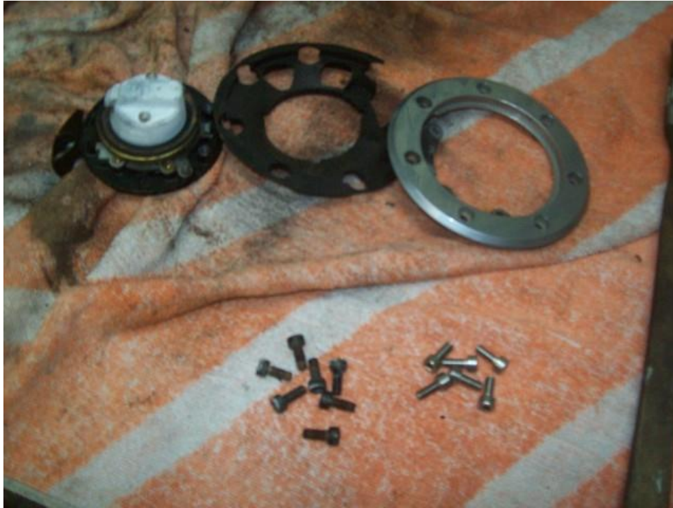
Deutlich sieht man den kalkigen, weißen Belag am Stopfen. Am Alu-Tankring ist Rost von den Schrauben. (rechts die neuen aus VA)
